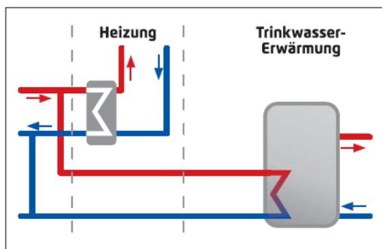
Prinzip IDS mit direkt angeschlossenem Brauchwasserspeicher
